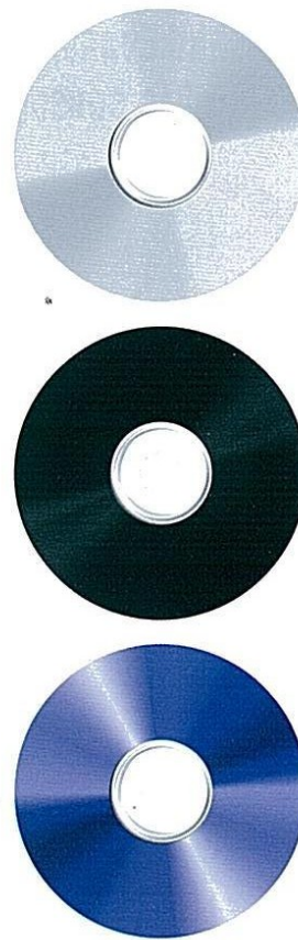
Comparativo das mídias que encontramos em alta definição. A primeira, transparente-metálica, é de um disco de Blu-ray original, fabricado pela Microservice. A segunda, de cor preta, é um exemplo de mídia de Blu-ray gravável, ou BD-R. Já a última, reprodução de um dos discos "piratas", é um DVD-R tradicional, de dupla camada, de tonalidade roxa.
